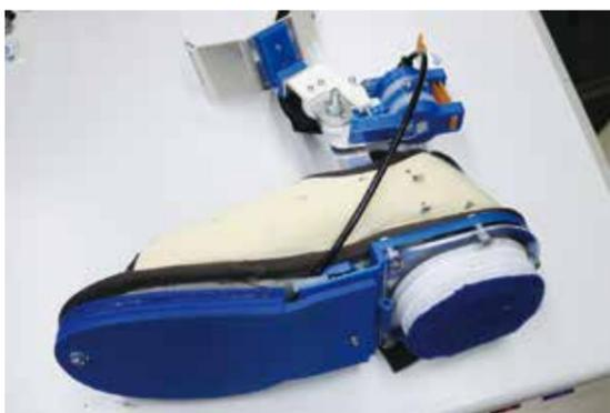
自分の体重をエネルギーとして、つま先を上げる動作を歩行に合わせて行う歩行支援シューズ。踵のポンプに体重がかかると空気が圧縮されてペロースに送られ、つま先が地面から離れた瞬間に空気を外に捨てるような状態になると、バネが元に戻ろうとする力が作用して、つま先が上がる仕組み。
