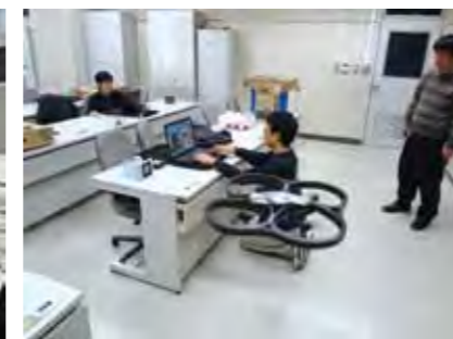
(写真3) ラボ活動の様子(カメラとマーカを用いたAR.Droneの追尾システム)
