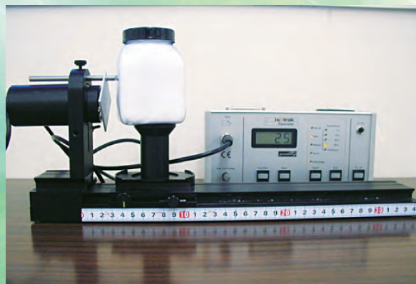
図2 GM計数装置による放射線計測
