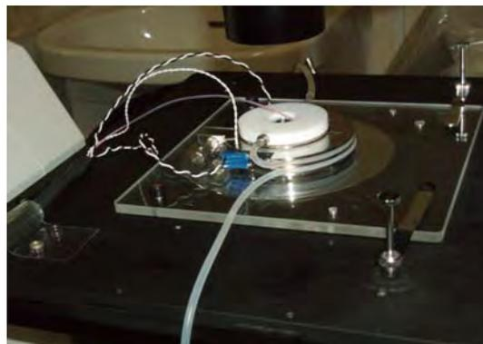
図1. 新規開発培養チャンバーの本体
