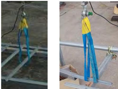
(a) 部材の曲げ試験 (b) ビスの引抜き試験
