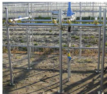
図-1 杭の引抜き試験機概観
