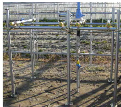
図-1 杭の引抜き試験機概観
