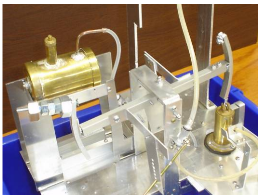
図9 弁機構を改良した総アルミのエンジン
